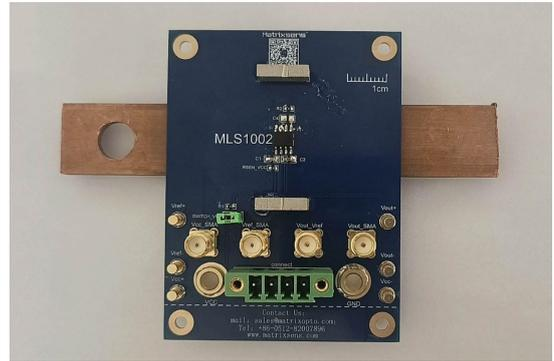
图 9 Matrixsens 线性平行磁场检测芯片应用板
